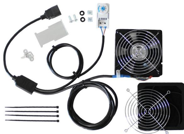
Vorverdrahteter Kompaktventilator zur Befestigung am Gehäuseboden-, Decke im Inneren eines Wandverteilergehäuses. Die Luftförderrichtung ist ‚Ins Gehäuse hinein‘. Die Lüfterseite welche ins Gehäuseinnere zeigt, ist mit einem Metallschutzgitter versehen. Der Rotor des Lüfters ist kugelgelagert und kann somit in allen drei Raumachsen betrieben werden. Ein Thermostat Schließer ist bereits verdrahtet.
