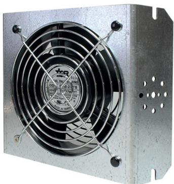
Lüftereinheit 230V AC für Schaltschrank, Wandverteilergehäuse, Datensschrank, Server-Rack und viele weitere Anwendungen. Mit beiliegendem Clip für Hutschienenmontage (TS35) zum Schnelleinbau. Lüfteranschluss Stromversorgung für 230V AC: Lüsterklemme 2-polig. sowie Erdungsschraube für 4mm Ringkabelschuh für den Lüfter-Erdungsanschluss.
