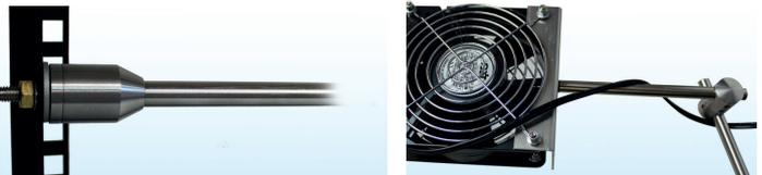
Der Kompaktventilator ist kugelgelagert und wird weltweit erfolgreich im Dauerbetrieb eingesetzt. Die knapp 160m<sup>3</sup>/h freiblasende Luftmenge erzielt eine effiziente Windbildung, um unterschiedlichen Wärmeproblemen zu begegnen. Varianten mit EC-Motor oder für eine Betriebsspannung von 24V DC sind ebenfalls lieferbar. Fragen Sie bitte bei uns an!
