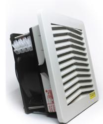
Wenn die passive Schaltschrankkühlung nicht ausreicht ist ein Schaltschrankfilterlüfter unumgänglich. Die kühle Umgebungsluft wird von dem Lüfter angesaugt, über eine Filtermatte gereinigt und weiter in den Gehäuserinnenraum geleitet. Die entstandene, warme Luft verlässt über eine Auslassöffnung in der Gehäusewand das Gehäuse.
