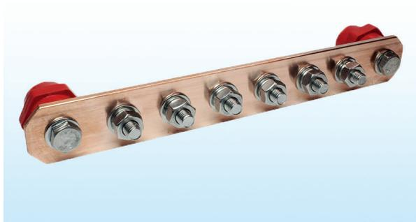
Der Vorteil der Potentialausgleichsschienen besteht in der Verwendung von Schlossschrauben am Vierkantdurchbruch, um die Montage so einfach wie möglich zu halten (Verdrehschutz).
